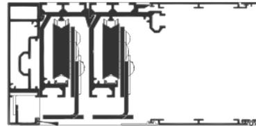
En el sistema autoportante, llamamos portabilidad a la distancia mínima entre puntos de fijación, y viene dada por los diagramas anexos en función del peso de las hojas.
